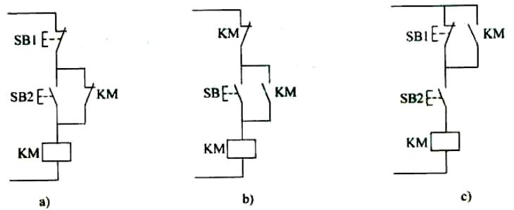
3、下图所示控制电路有些地方画错了，试加以改正并写出其工作原理。
